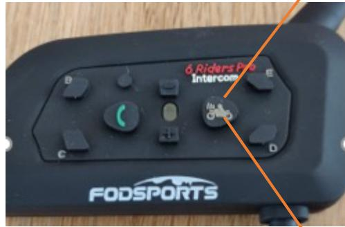
1) Allumez les 2 appareils avec le bouton portant l'illustration d'une « Moto » en maintenant le bouton enfoncé pendant environ 8 secondes. Maintenir le bouton enfoncé, même si la lumière s'allume rouge et ensuite clignotante bleue s'allume, jusqu'à ce que la led clignote rapidement en bleue et rouge rapidement (on peut alors relâcher le bouton « Moto »).
