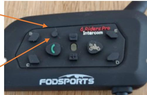
Pour éteindre l'appareil à la fin du match, il suffit d'appuyer sur le petit bouton au-dessus du bouton « téléphone vert ».
